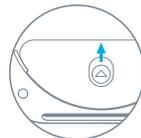
3. Cambia las baterías. Coloca los polos positivo + y negativo - de acuerdo con las indicaciones del compartimento de las baterías.
